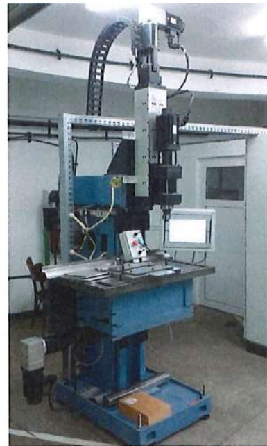
b) Laborator de prelucrări prin frecare cu element activ rotitor;
