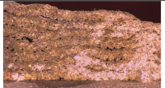
Figura 18. Secțiune metalografică a probei 5, cu degradare locală a stratului depus după solicitarea mixtă uzură-vibrații
