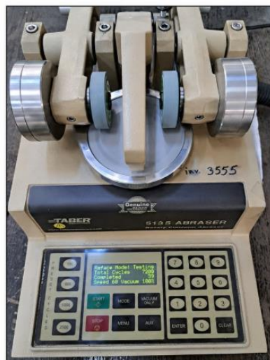
(a) TABER 5135 Abraser în timpul testării
