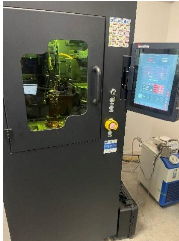
Figura 4. Echipamentul Insstek MX Mini DMT utilizat pentru depuneri metalice DED/LMD cu aport de pulbere
