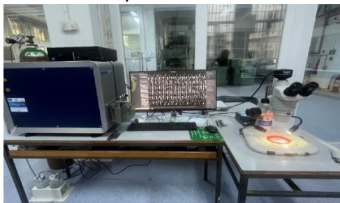
Figura 8. Sistem de microscopie optică utilizat pentru examinarea metalografică preliminară a zonelor depuse
