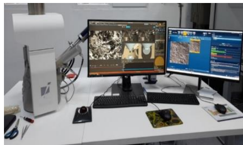
Figura 9. Microscop electronic de baleiaj cu analiză EDS utilizat pentru examinarea morfologiei și distribuției elementare
