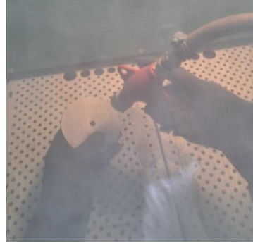
Figura 2. Sablarea substratului înainte de depunere, în vederea curățării și activării mecanice a suprafeței
