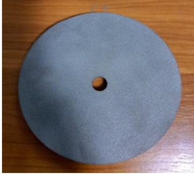
Figura 1. Substrat metalic circular din material feros utilizat pentru depunerile DED/LMD multi-pulbere
