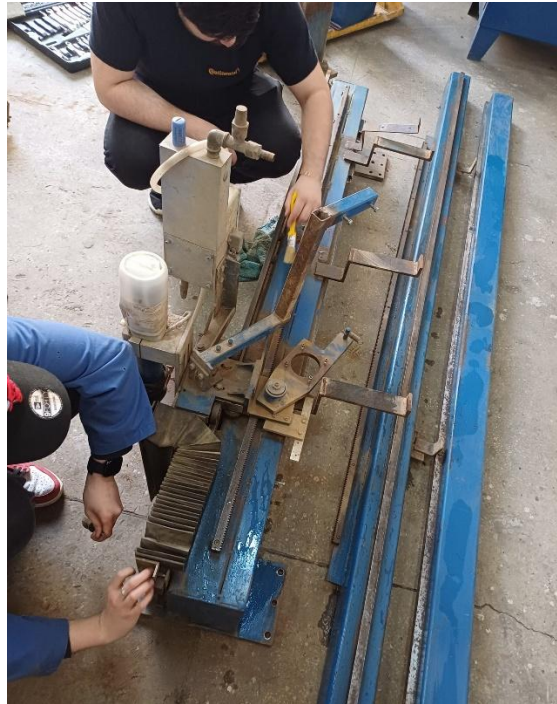
Fig. 3.2 Dezasamblare portal de tăiere CNC
