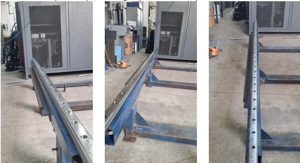
Fig. 3.3 Montare ghidaje de precizie
