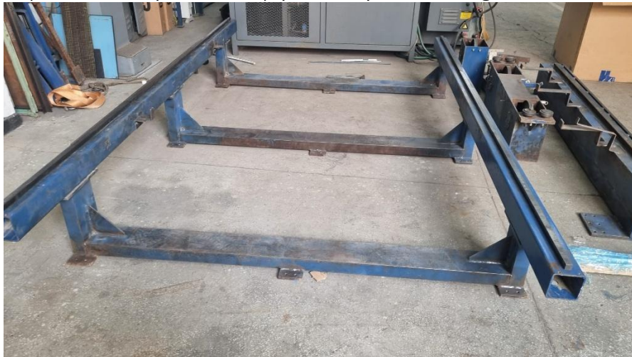
Fig. 3.1 Dezasamblare portal de tăiere CNC
