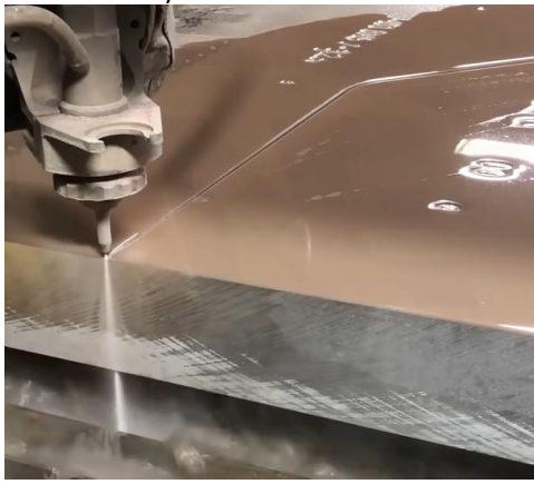
Fig. 6.1 Debitare cu jet de apă și abraziv
