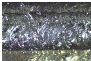
Figura 7. Imagine a suprafeței piesei printată 3D
