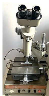
Figura 6. Echipament pentru testarea durității Zwick 3212
