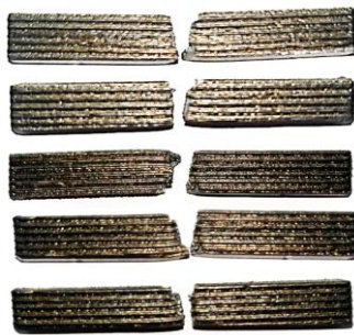
Figura 11. Rezultate teste a impact, compoziția 2: 25% Aly 718, 25% 316L, 25% Alloy H13, 25% Ti-6Al-4V
