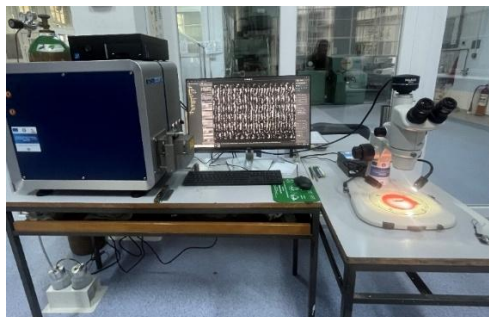
Figura 4. Microscopie electronică cu scanare și spectroscopie cu raze X cu dispersie de energie: SEM EDX
