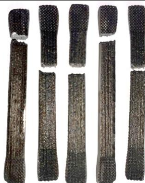
Figura 10. Rezultate teste de tracțiune, compoziția 2: 25% Aly 718, 25% 316L, 25% Alloy H13, 25% Ti-6Al-4V
