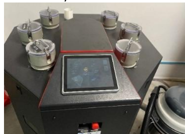
Figura 2. Echipamentul de amestecare și distribuie a pulberilor metalice din dotarea ISIM Timișoara
