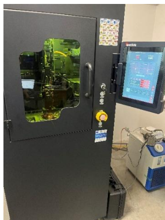
Figura 3. Echipamentul de printare 3D InssTech MX-Mini DMT din dotarea ISIM Timișoara
